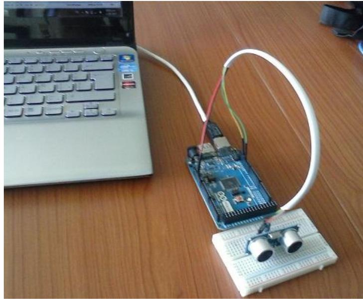
**Ilustración 63. Conexión del sensor ultrasónico a un equipo de escritorio**
