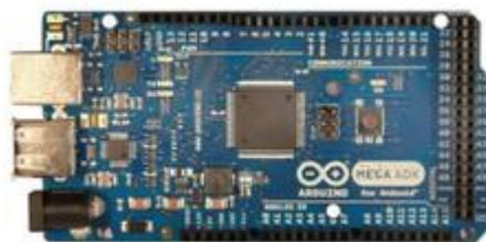
**Ilustración 22** Tableta Arduino mega ADK rev 2
